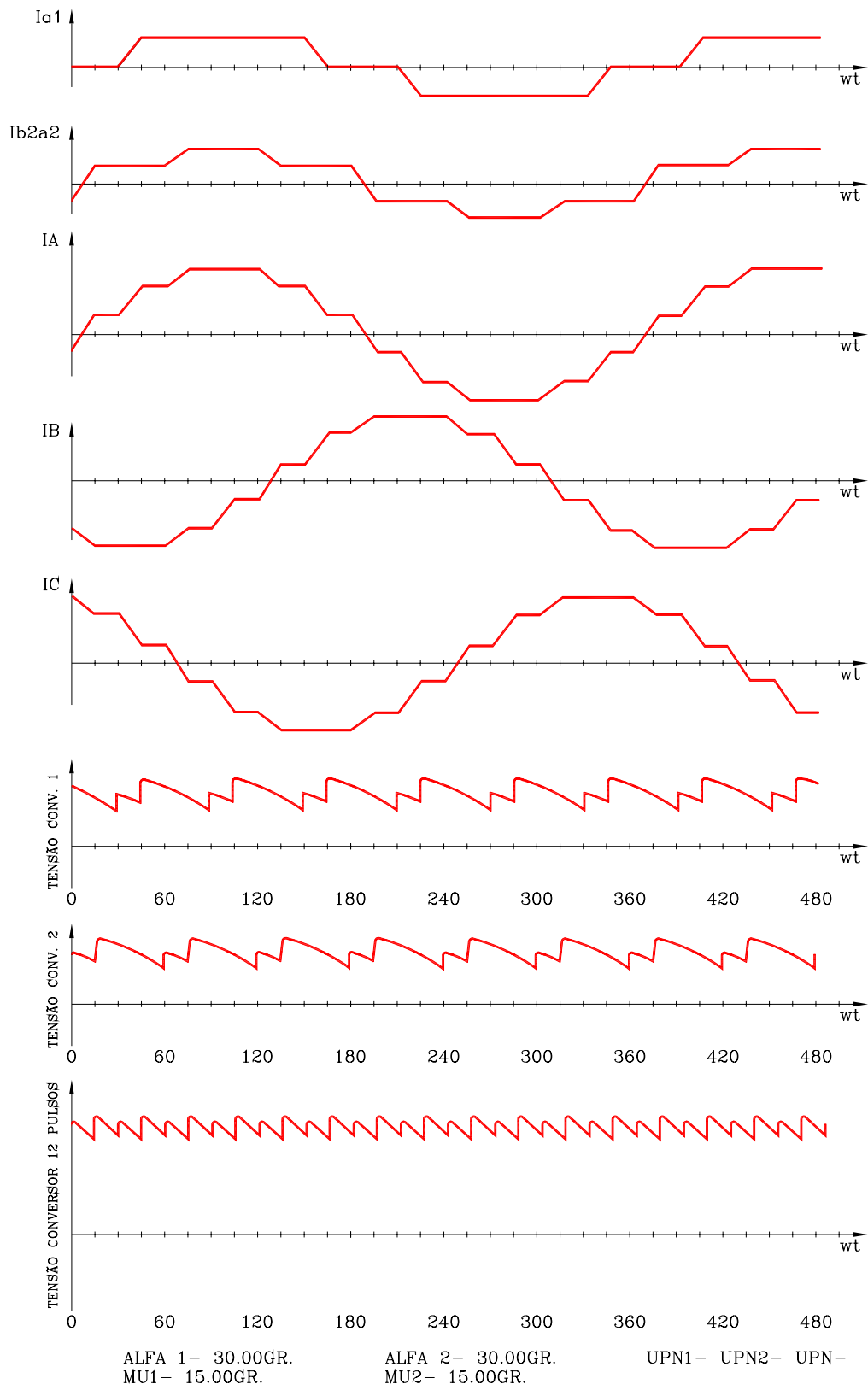
FIGURA 6 - FORMAS DE ONDA PARA CONVERSOR DE 12 PULSOS \alpha = 30^\circ , \mu = 15^\circ
